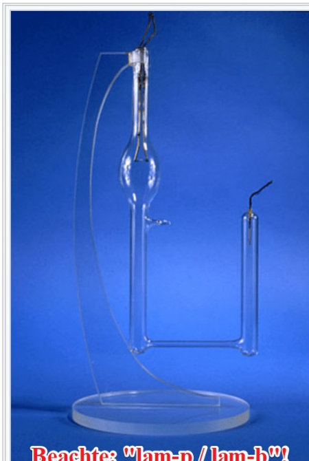
Beachte: "lam-p / lam-b"! Eine Krypton-86-Lampe , deren zinnoberrrote Spektrallinie (Wellenlänge ca. 606 nm ) zwischen 1960 und 1983 zur Meterdefinition herangezogen wurde
